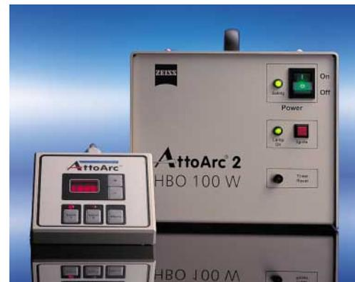
*Elektronischer Dimmer für Hochdrucklampen: AttoArc 2*
